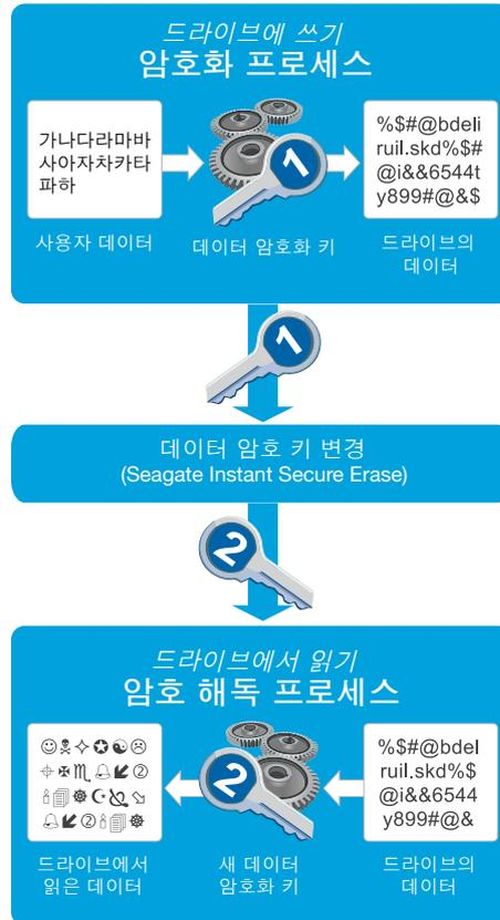
그림 1. Seagate Instant Secure Erase 프로세스
