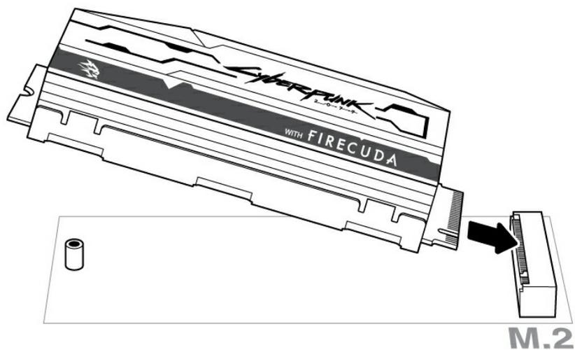
8. FireCuda SSD を押さえながらマウント用ネジを取り付けます。SSD が固定されたことを確認します。
