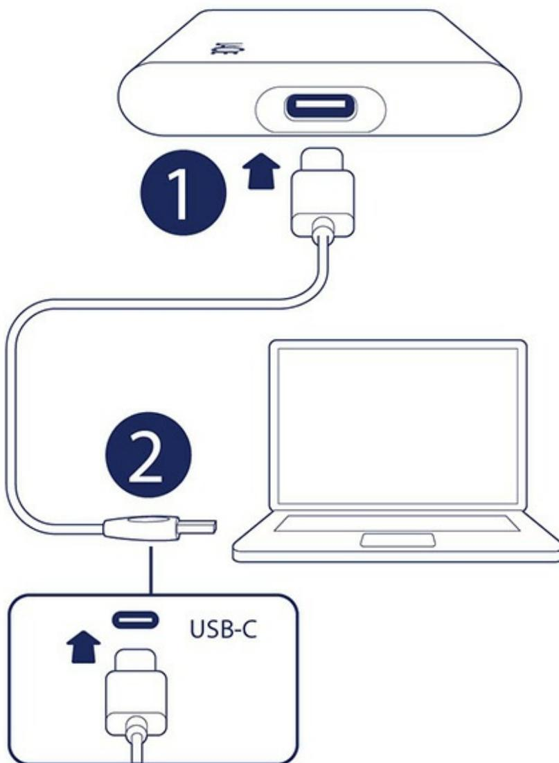
**i** Puede conectar su dispositivo LaCie a un puerto USB-A de su computadora. El cable USB-C a USB-A no viene incluido con este dispositivo.
